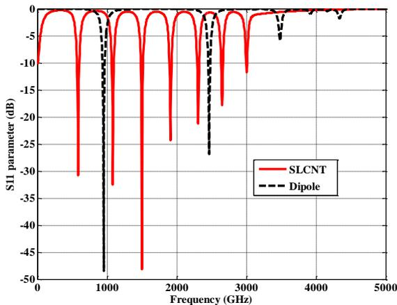
Fig 2: S<sub>11</sub> parameter of a SLCNT and SWCNT dipole antennas.
