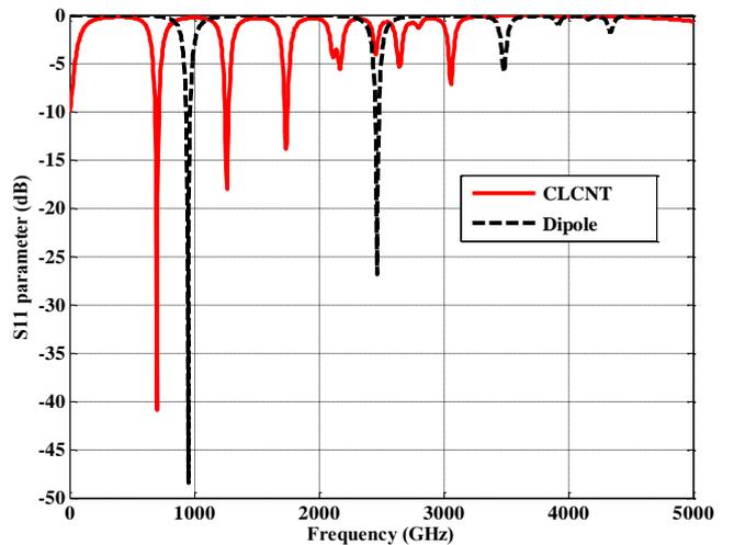
**Fig 8:**  $S_{11}$  parameter of CLCNT and SWCNT dipole antennas.
